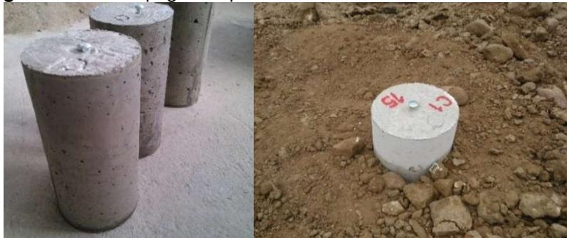
Com a estação total se faz leituras semanais das distâncias horizontais e verticais e o ângulo entre os marcos superficiais instalados na célula e os marcos fixos inseridos em locais que não há movimentação. Em seguida se faz a diferença da leitura inicial com as subsequentes, permitindo a medição dos deslocamentos.
