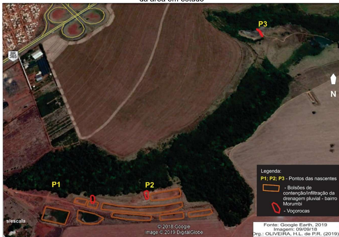
Figura 2. Pontos das nascentes analisadas, erosões e bacias de infiltração de drenagem pluvial em porção da área em estudo
