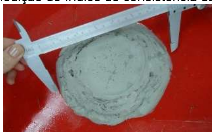
Figura 3. Medição do índice de consistência da argamassa
