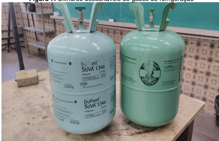
Figura 7. Cilindros descartáveis de gases de refrigeração
