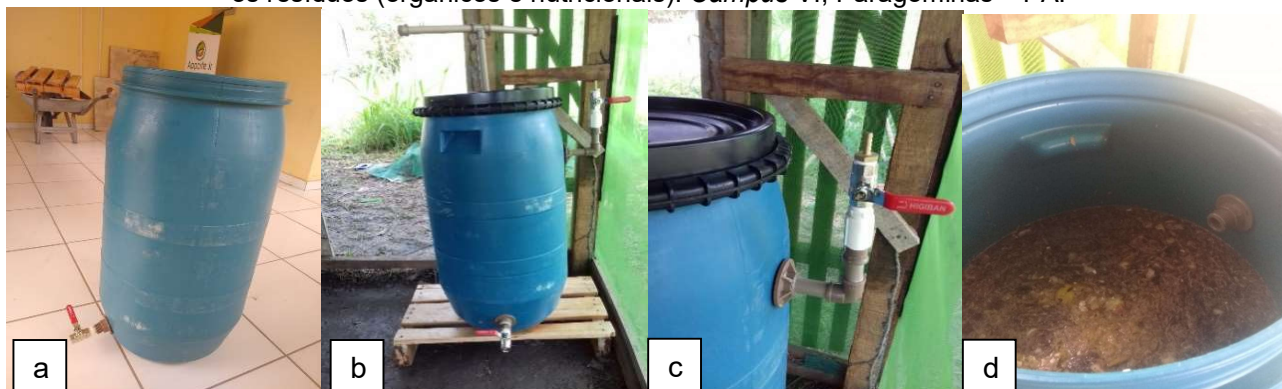
Figura 2. Posição da angulação do dreno em 15° que ajuda na retirada do biofertilizante, pois, fica levemente inclinado para baixo; b) dreno já aplicado na bombona e alocado em espaço reservado para a composteira; c) saída de gás, realocada para a lateral da bombona; d) distância entre o ponto de vasão do gás e os resíduos (orgânicos e nutricionais). Campus VI, Paragominas – PA.
