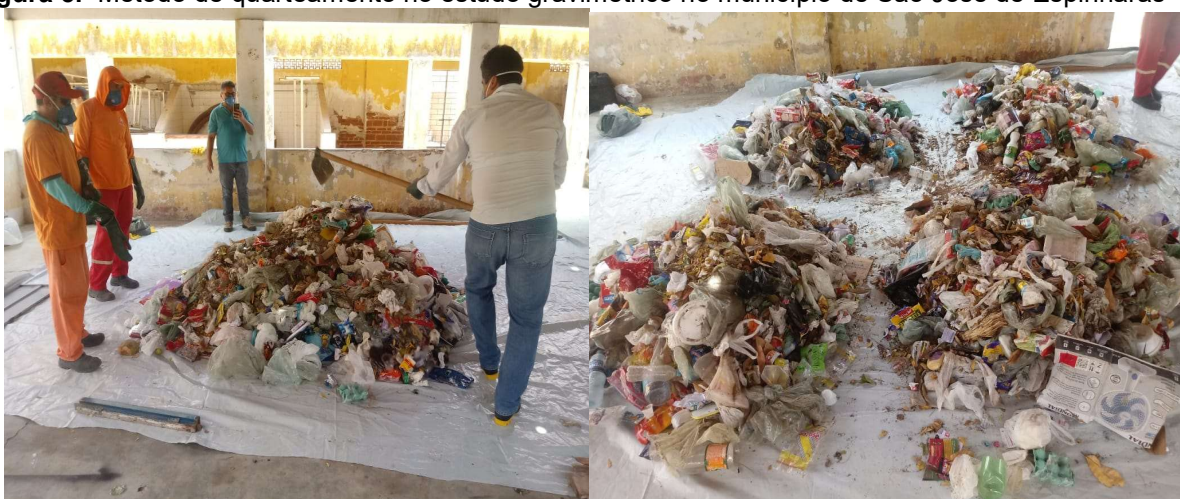
Figura 5. Método de quarteamento no estudo gravimétrico no município de São José de Espinharas -PB
