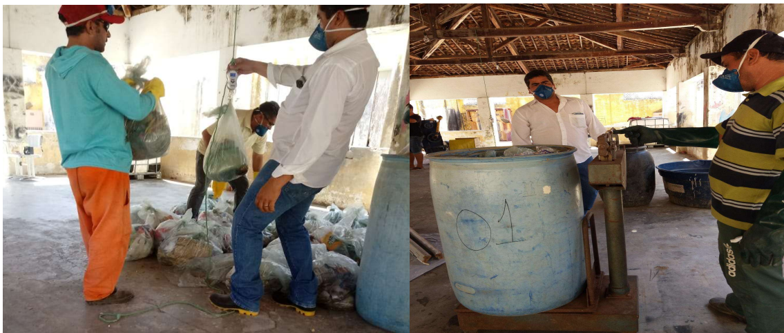
Figura 4. Pesagem das sacolas e bombona com os resíduos para o estudo gravimétrico no município de São José de Espinharas – PB
